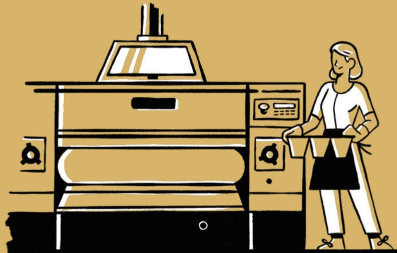
Il processo d'integrazione viene completato con la macinazione a cilindri: in questo modo viene calibrata la granulometria della farina, così da garantire grandi prestazioni e costanza nel tempo.
